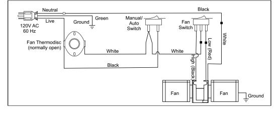
Fan Wiring Diagram
