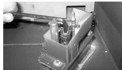
12. Retirer le moteur pas-à-pas pour gaz naturel en enlevant les 3 vis dans les endroits indiqués ci-dessous. Le remplacer par le moteur pas-à-pas pour propane et le fixer à l'aide des 3 vis.
