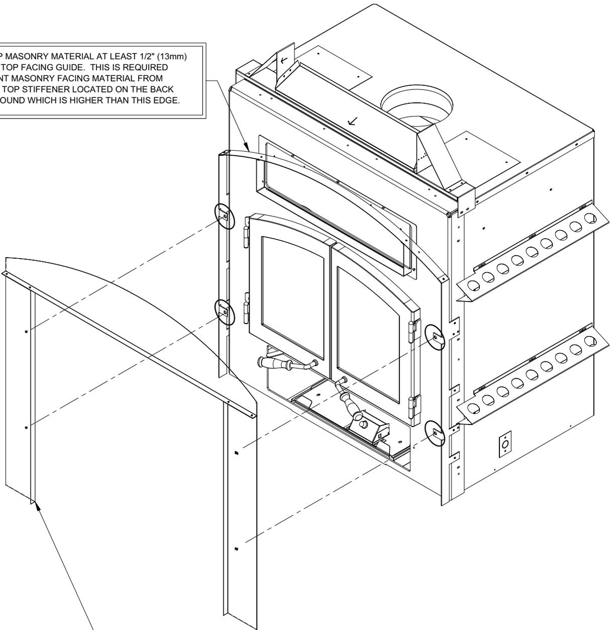
INSTALL THE SURROUND TEMPLATE ONTO THE UNIT WITH THE SAME MOUNTING SCREWS AS THE SURROUND.
