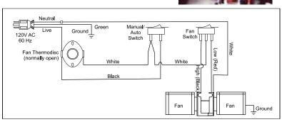
Fan Wiring Diagram
